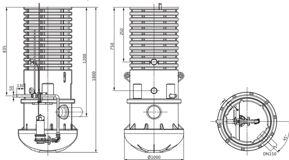
Размеры и габаритные чертежи: Wilo-DrainLift WS 830 E/2300
